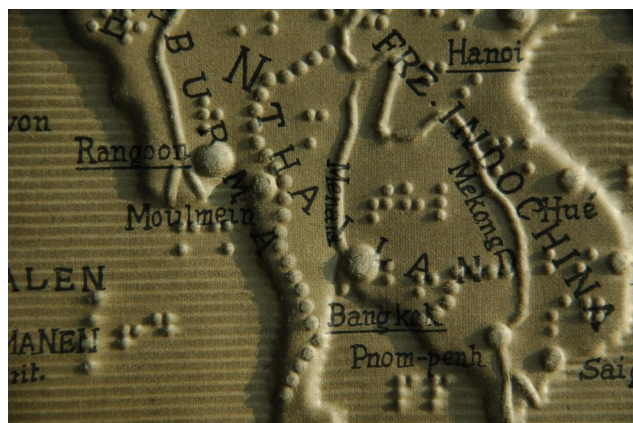
Stara mapa tyflogiczna produkcji niemieckiej (rok 1906) wykonana w tłocznym głęboko preszpanie.
