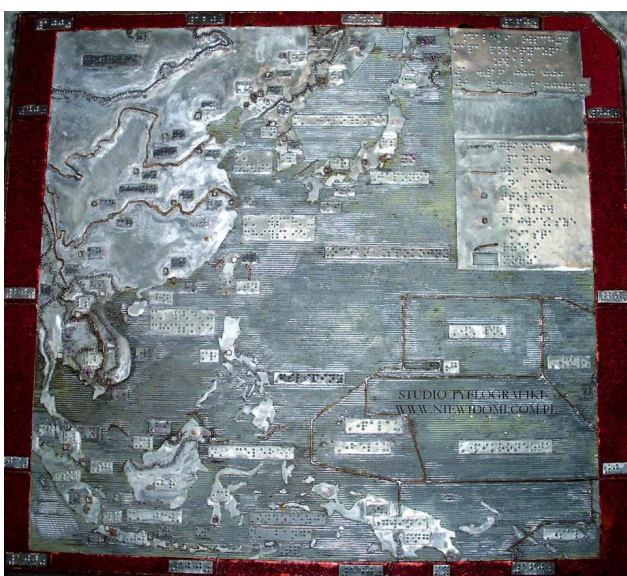
Metalowa matryca do tłoczenia próżniowego map tyflogicznych wydawanych przez Główny Urząd Geodezji i Kartografii oraz Polski Związek Niewidomych w latach 80. i 90.
